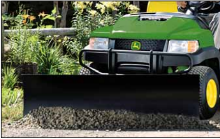
Radlice 1,37 m Má tři pozice, výměnné ostří a dva seřiditelné skluzné dorazy. Odděleně prodáván systém rychlého připojení, Quick-Attach system, Vám umožní nářadí rychle připojit a zase ho odpojit. Volitelné označení pluhu Vám umožní lépe sledovat okraje radlice.
