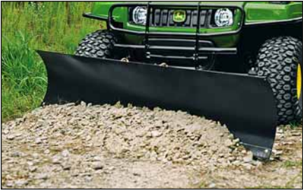
Radlice 1,83 m Pro nenáročné použití. Má tři pozice, automatické zvedání a dva seřiditelné skluzné dorazy. Lze ji velmi jednoduše připojit pomocí dvou čepů a jednoho kloubu.
