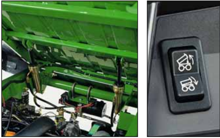
Automatické sklápění korby Ovládejte pomocí tlačítka, které je umístěno na přístrojové desce, sklápění korby pohodlně z místa řidiče. A to i když je korba plně naložená*.
