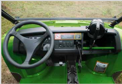
Ovládání v maličku. Všechny ovladače, které jsou navíc barevně odlišené, jsou umístěné tak, aby na ně mohla obsluha snadno dosáhnout.
