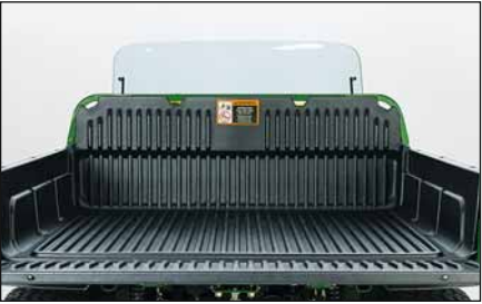
Výstelka korby Chrání korbu před poškozením a bezešvý přechod mezi korbou a zadními výklopnými dvířky zabrání tomu, aby se v prostoru mezi nimi zachycovaly jakékoliv zbytky materiálu či nečistoty.
