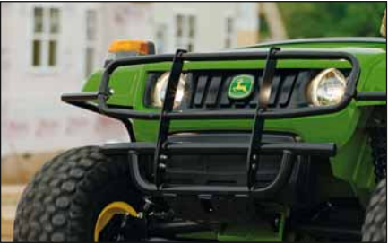
Ochranný rám Robustní ochranný rám chrání předek vozidla.
