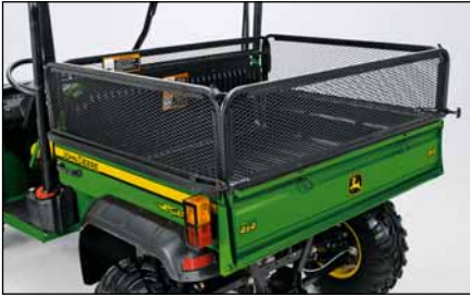
Zvýšení korby Čtyři stěny zvýší korbu o celých 533 mm a zvýší objem nákladového prostoru na 0,74 m³.
