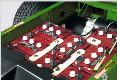
Baterie Gatoru TE , které používají 48 voltový systém, mají více olova, než je typické u jiných elektrických užitkových vozidel, což jim umožňuje vydržet déle bez dobíjení.
