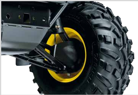
Zastavte na místě. Odolné hydraulicky ovládané kotoučové brzdy s dvojitým okruhem hlavního válce a většími třmeny zajišťují maximální brzdovou sílu.
