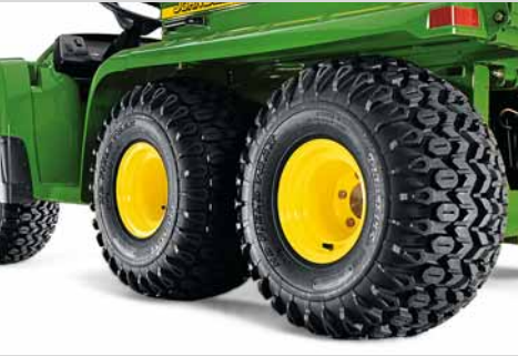
Vychutnejte si tu nejvyšší trakci a zůstaňte zároveň ohleduplní k trávníku – třínápravová konstrukce.
