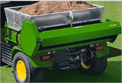
Úpravy. Převrtník TD100 pro úpravu povrchů. Obsahuje bežešvý dopravník a má kapacitu 0,5 m³. Kontejner je vyroben z galvanizované oceli.
