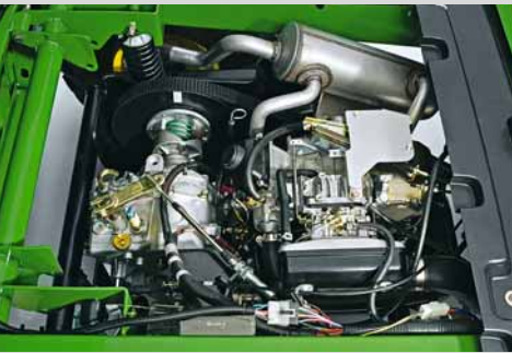
Více výkonu. Nový, větší vznětový motor o objemu válců 854 cm³ má vyšší výkon a zároveň je velmi tichý.
