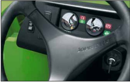
Ukazatele a měřidla Analogický elektronický rychloměr a volmetr jsou integrované v přístrojové desce.
