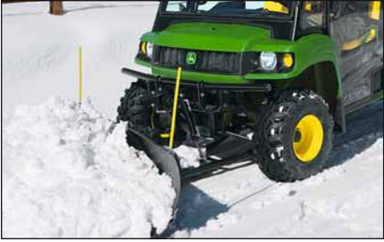
Radlice – V 1.83m Rychle připojitelná radlice ve tvaru V je zkonstruována tak, aby jste mohli rychleji a lépe odstraňovat sněh a nečistoty. Snadno mění tvar z tvaru V do tvaru přímé radlice. Zahrnuje také dva seřiditelné skluzné dorazy. (řada HP a T vyžaduje nářadí pro připevnění).
