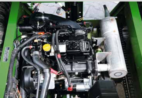
Nastartujte s úsporným a výkonným vznětovým motorem o objemu válců 854 cm³.
