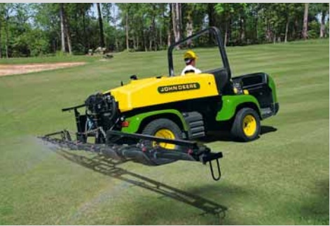
Postřikování. Postřikovač HD200 má nádrž na 750 litrů a rozsah rozstřikovací šířky 4,6 – 6,4 metrů.
