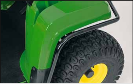
Ochranný rám blatníků. Ochranný rám blatníků je spojen s nárazníky a předním ochranným rámem a chrání vozidlo ze stran.
