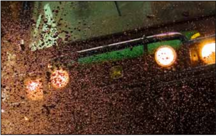
Přidavné světlomety Dva 55 wattové přidavné světlomety se dají namontovat na přední ochranný rám a umožní Vám osvětlit větší prostor.
